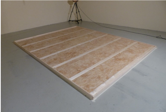
Bild 1: Rahmenkonstruktion mit Bedämpfung
